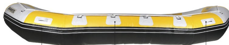
Nafukovací podlážka vrchní vrstva PVC 1000 DTEX zesponu PVC 2000 DTEX Vrchní část válců vystužena PVC 1000 DTEX Všité a lepené vnitřní válce Úchyty na chodidla
