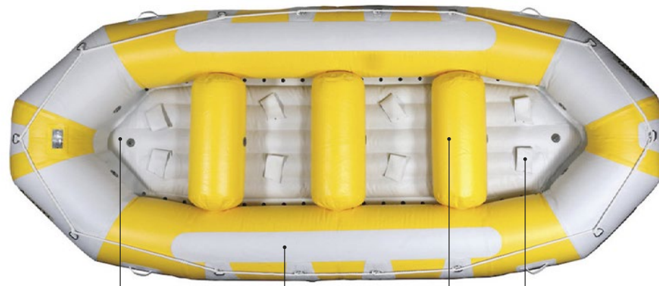
Nafukovací podlážka vrchní vrstva PVC 1000 DTEX zesponu PVC 2000 DTEX Vrchní část válců vystužena PVC 1000 DTEX Všité a lepené vnitřní válce Úchyty na chodidla
