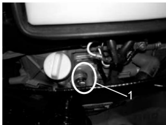
1.okénko kontroly hladiny oleje
